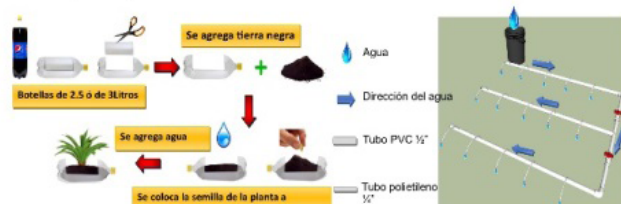
Figura 1: Esquema de elaboración del prototipo de techo ecológico, corte de botellas de PET y sistema de riego por goteo.
