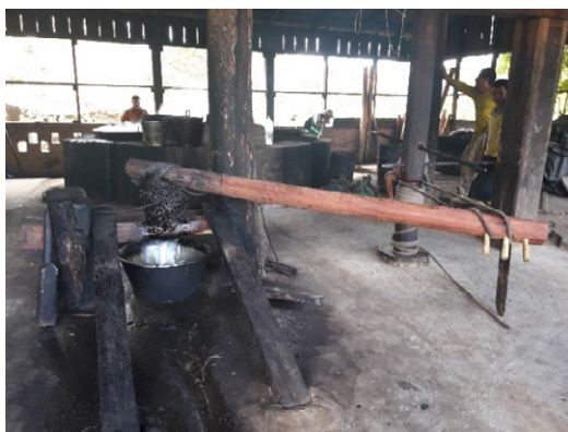
Figura 16. Torcedora como tecnología apropiada para la extracción de Bálsamo.
