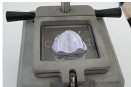
Fig. 3 Máquina de Vacío para construir BT de PVC
